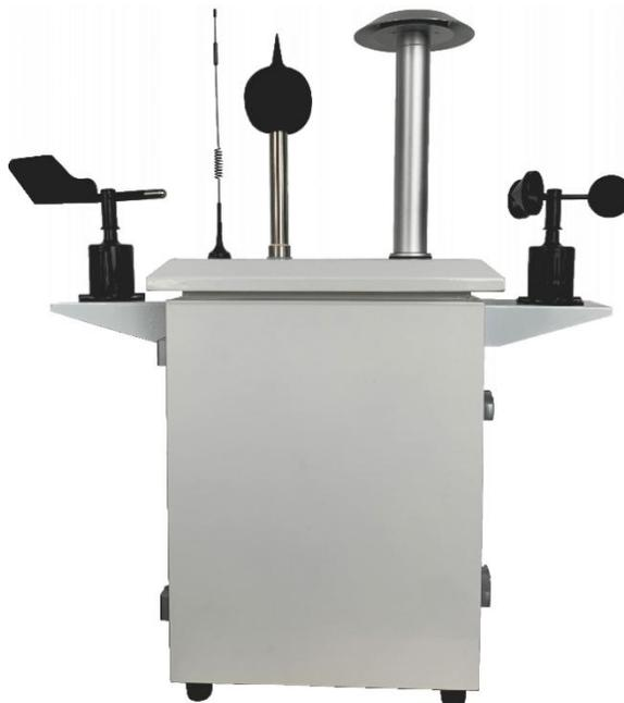
用户可根据自身需求，挑选扬尘噪声在线监测系统的检测参数。可选项包括但不限于：颗粒物（PM2.5、PM10、TSP）、噪声、以及风速、风向、温度、湿度、气压等气象参数。
